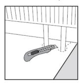
Traffic CV-Böden sollten grundsätzlich verschweißt werden. Dies kann mittels Kaltschweißmittel erfolgen. Decken Sie die Naht vorher mit geeignetem Klebeband ab und pressen dieses mittels einer Andrückrolle fest an. Durchtrennen Sie das Klebeband dann entlang der Naht mit einem Rollmesser. Drücken Sie die Nadel der Tube tief in die Naht hinein (Kaltschweißmittel Typ A), fahren in dieser entlang und dosieren Sie das Kaltschweißmittel so, dass eine ca. 5 mm breite Benetzung des Klebebands erfolgt.
